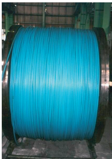
Figura 3-4 Bobina com 11t de cordoalha
